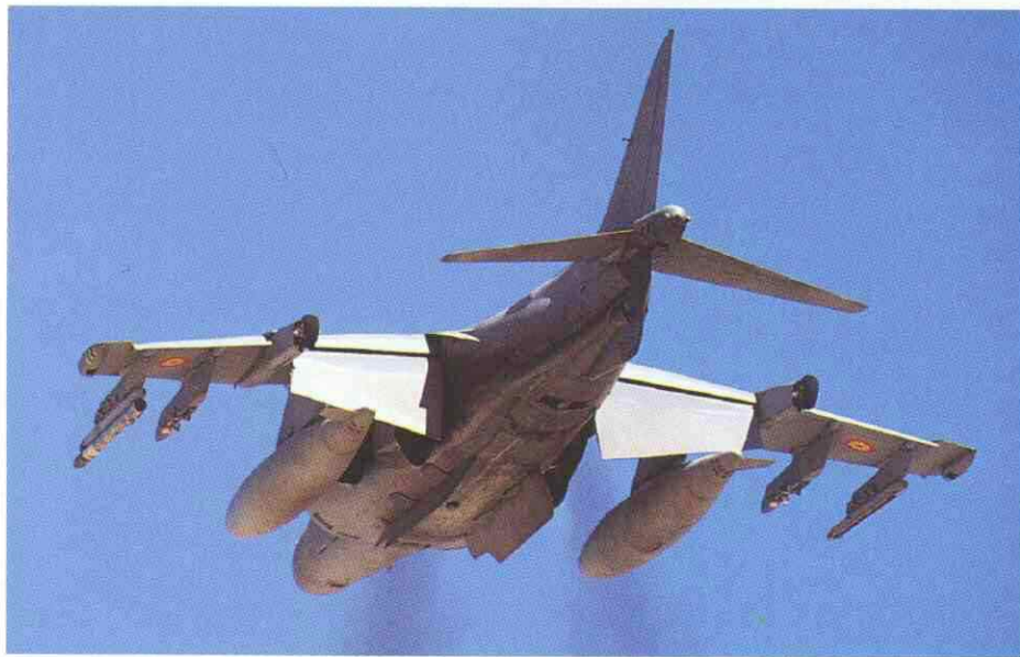
Alas. El nuevo diseño permite una mayor carga alar y ángulos de ataque inviables con el Bravo .
